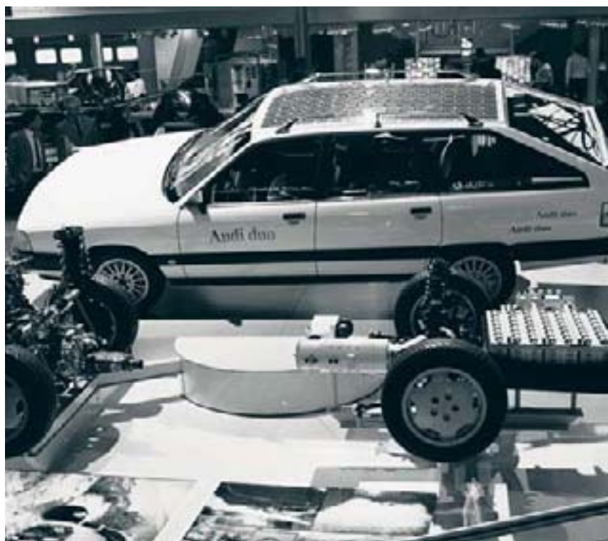
Kaum zu glauben, aber wahr: Bereits vor 20 Jahren präsentierten die Ingolstädter mit dem Audi 100 Duo Typ 44 ein serienreifes Hybridfahrzeug, das seiner Zeit weit voraus war.
