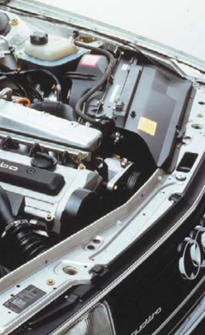
Höchste Evolutionsstufe: Der 20-V-Turbomotor brachte dank Quattroantrieb seine 220 PS/162 kW sicher auf die Straße.
